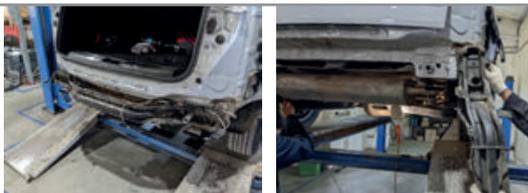
**ШАГ 2.** Установите левую закладную пластину в отверстие лонжерона, как показано на фотографии. Установите закладную пластину с двумя гайками в технологическое отверстие треугольной формы в правой, нижней части кузова автомобиля, как показано на фотографии.
