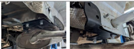
**ШАГ 4.** Установите балку ТСУ, используя штатные шпильки автомобиля, прикрутите штатными гайками М8, и, совместив отверстия в балке ТСУ с отверстиями в кронштейне, прикрутите болты М10 с гайками М10 через шайбы 10 и шайбы 10 гроверные.
