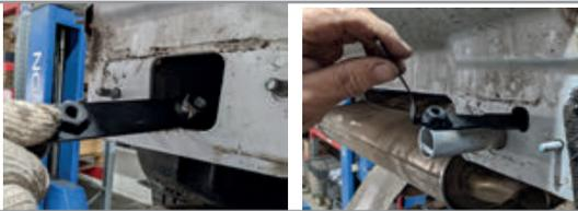
**ШАГ 3.** Установите левый кронштейн, совместив отверстия в кронштейне с отверстиями в лонжероне автомобиля и соединив всё при помощи болтов М10х1,25х30 через шайбы 10 увеличенные и шайбы 10 гроверные.
