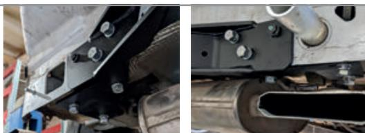
**ШАГ 5.** Рассверлите в пластиковом бампере отверстия диаметром 16 мм. На свободную шпильку наденьте 2 шайбы 8 увеличенные.
