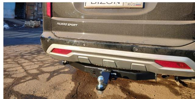
При транспортировке велоплатформы рекомендуется заменить штатный кронштейн тсу 305.417-01 на силовой кронштейн ТСУ 305.418 BIZON.
