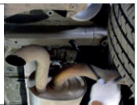
**ШАГ 2.** Выпрямите закладную, держа её за шпильку. Совместите отверстия в закладной и в лонжероне. Совместите кронштейн боковой с отверстиями в лонжероне и закрепите кронштейн болтом M10x1,25x40, через шайбу 10 и гроверную шайбу 10. А так же гайкой M10 с шайбой 10 и гроверной шайбой 10.
