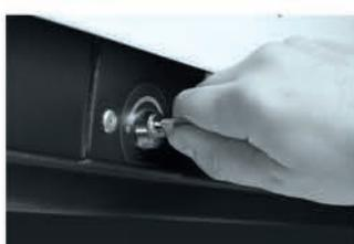
7 Для открытия автобокса, отстегните регулируемый натяжной замок в носовой части автобокса. Вставьте ключ в личинку замка и поверните против часовой стрелки (при открытом автобоксе ключ остаётся в замке).
