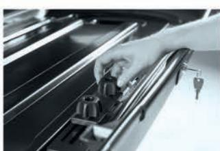
5 Затяните гайки «барашек» усилием пальцев, не используя при этом плоскогубцы или любые другие инструменты!!!.
