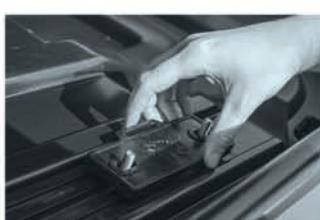
3 Придерживая скобы изнутри автобокса, установите проставки усилителя и наживите гайки «барашек».
