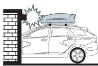
При заезде в гараж, крытый автопаркинг и пр., убедитесь, что высота автомобиля с автобоксом не превышает высоту въезда
