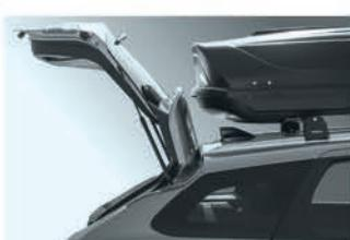
4 Выровняйте автобокс относительно центральной оси автомобиля. Установите автобокс так, чтобы открытая дверь багажного отделения не упиралась в него.
