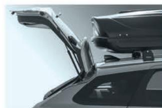
4 Выверните автобокс относительно центральной оси автомобиля. Установите автобокс так, чтобы открытая дверь багажного отделения не упиралась в него.
