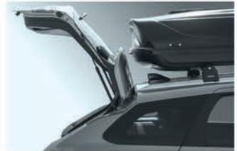
4 Выровняйте автобокс относительно центральной оси автомобиля. Установите бок так, чтобы открытая дверь багажного отделения не упиралась в него.
