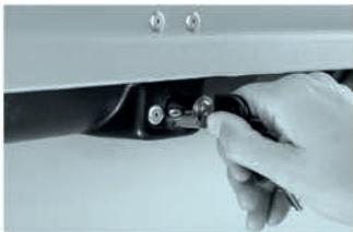
9 Для закрытия автобокса плотно закройте крышку и нажмите на кнопку замка.
