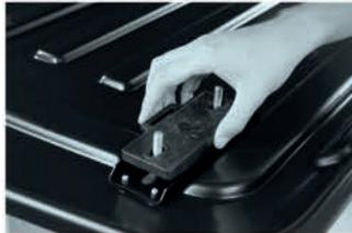
3 Придерживая скобы изнутри автобокса, установите прокладки усилителя и наживите гайки «барашек».
