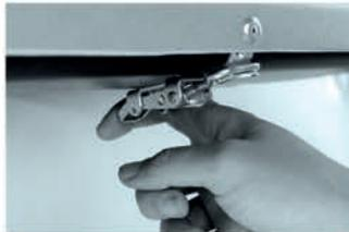
7 Для открытия автобокса отстегните 2 регулируемых натяжных замка в носовой и задней части автобокса.
