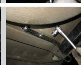
**ШАГ 5.** Установите кронштейн крепления электрической розетки.
