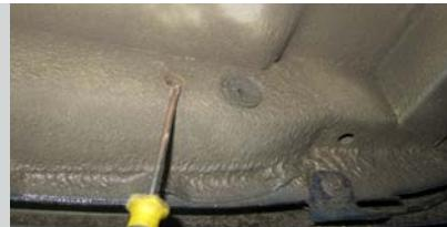
**ШАГ 3.** Для установки фаркопа совместите отверстия в сварном кронштейне с резьбовыми отверстиями кузова автомобиля и соедините всё с помощью болтов M10, через шайбы увеличенные M10 и шайбы пружинные M10.
