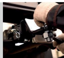
Тип соединения: шаровый; Диаметр сцепного шара: 50 мм.; Масса комплекта ТСУ 09121501: 31,2 кг.
