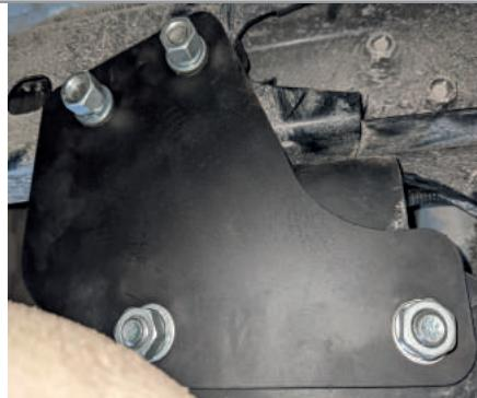
**ШАГ 3.** Наживите балку ТСУ на левый и правый основные кронштейны. Заденьте положение балки, используя для крепления болты M12x1,25x40, шайбы 12 и гроверные, шайбы 12 и гайки M12x1,25.
