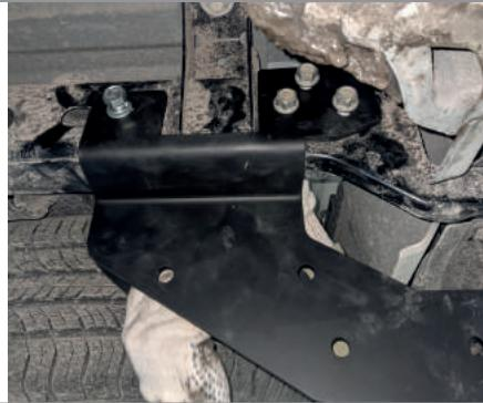
**ШАГ 2.** Установите в правый лонжерон закладную деталь таким образом, чтобы шпильки закладной детали прошли через соответствующие отверстия, указанные на фото справа. Установите усилитель кронштейна, используя болты M12x1,25x40, гайки M12x1,25, шайбы 12 и шайбы 12 гроверные. Повторите ту же операцию с левой стороны автомобиля.
