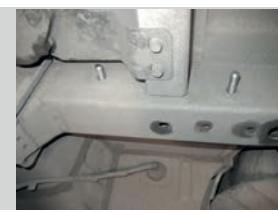
**ШАГ 2.** Установите боковые кронштейны и закрепите их с помощью гаек M12 через шайбы M12 с двух сторон лонжерона и шайбы M12 пружинные. Кронштейны не затягивайте.
