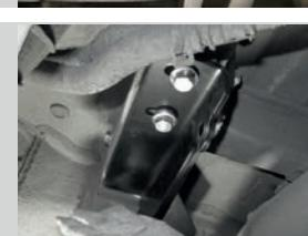
**ШАГ 5.** Затяните все резьбовые соединения. Установите шар в сборе. Зафиксируйте шар пальцем для фаркопа и проденьте в него шпллинт. Затяните нижний винт крепления M10x20. Установка завершена.
