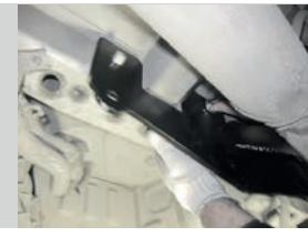
**ШАГ 3.** Установите центральный кронштейн, совместив отверстия в кронштейне центральном с отверстиями в боковых кронштейнах и соедините всё с помощью болтов M10x40x1,25, гаек M10x1,25, шайб M10 и шайб пружинных M10.
