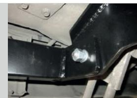
**ШАГ 4.** Для установки угловых кронштейнов, вставьте в технологические отверстия лонжеронов закладные пластины с гайками M12. Установите угловые кронштейны и соедините всё с помощью метизов из комплекта поставки, согласно схемы.
