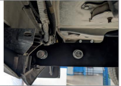
**ШАГ 4.** Установите съёмный шар в сборе и закрепите его пальцем гнутым гальванизированным со шплинтом пружинным игольчатым. Затяните шар ключом на 38 мм. Установите фиксирующий болт M10x20 снизу, **он используется для исключения технологических люфтов съёмного шара и только в ненагруженном состоянии! Перед сцепкой болт демонтировать!** Установите запаску и пыльник на место. Установите глушитель обратно.
