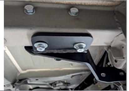
**ШАГ 3.** Установите балку ТСУ, соединив её с боковыми кронштейнами с помощью болтов M12x1,25x40, шайб 12, шайб 12 гроверных и гаек M12x1,25. Не затягивайте соединения. После установки балки отрегулируйте положение балки относительно бампера. Затяните все соединения.
