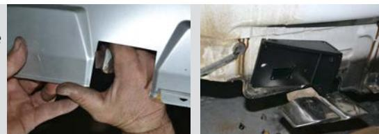
**ШАГ 2.** Закрепите кронштейны в нижней части лонжеронов болтами M10x30 через шайбы M10 и гроверные шайбы M10. Болты не затягивать. Установите центральный кронштейн (Поз. N) между боковыми кронштейнами и закрепите его с помощью болтов M8x40, через шайбы M10, гроверные шайбы M10 и гайки M10. Болты не затягивать.
