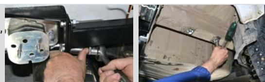
**ШАГ 5.** Установите усилитель заднего бампера на штатные метизы. Установите задний бампер и задние фонари согласно инструкции по ремонту автомобиля. Установите шар в сборе (Поз. М). Зафиксируйте шар в сборе с помощью пальца с клипсой и фиксирующего болта (Поз. С). Установка завершена.
