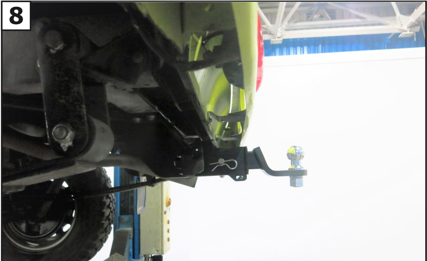
Установить переходник (5), закрепив с помощью штифта (7) и шплинта (8). Зафиксировать переходник болтом M10x20 (11) - фиксацию использовать только без нагрузки. Установить на переходник шар (6), закрепив гайкой M24 (21) с шайбой 24 пружинной (22).
