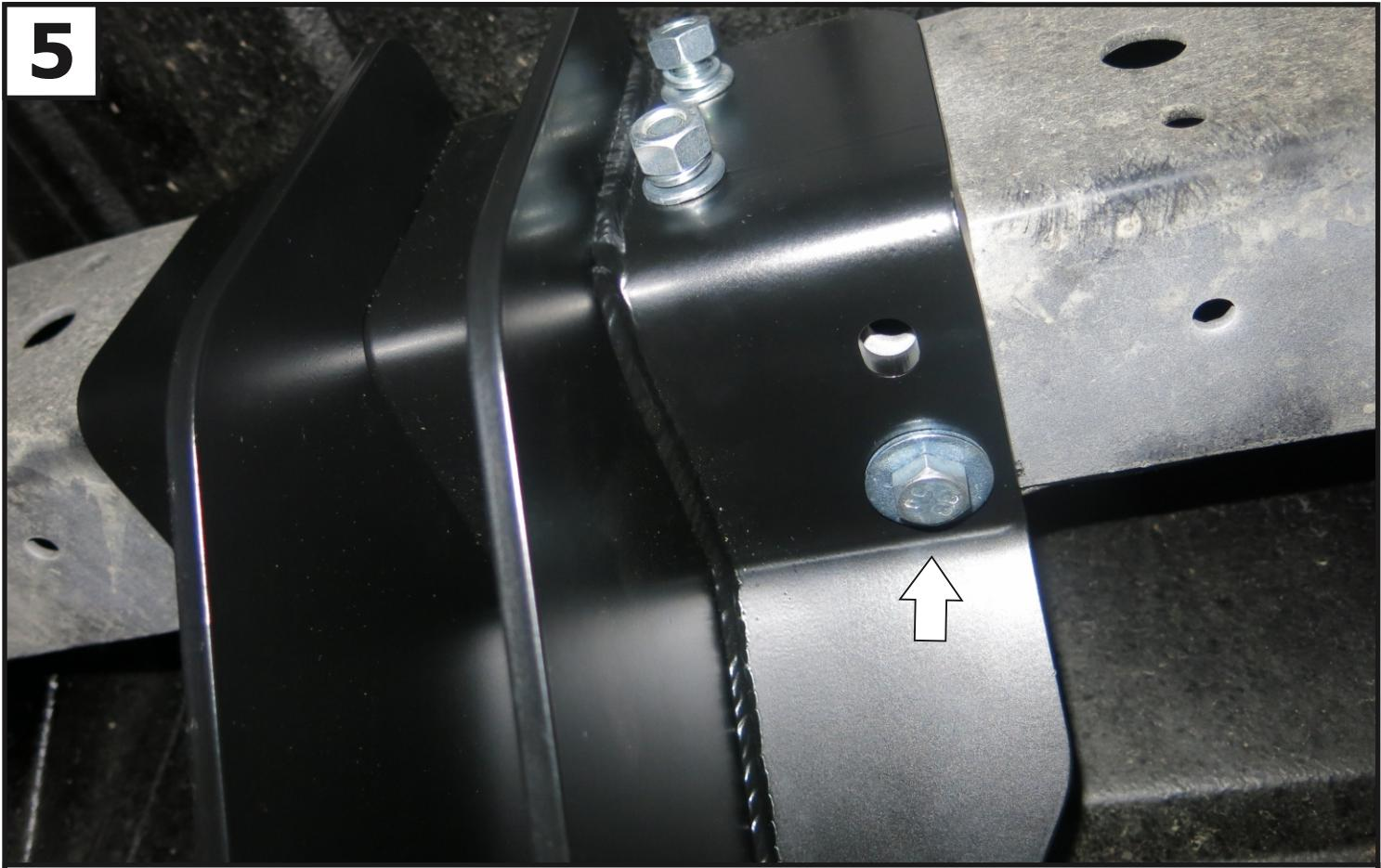
Дополнительно закрепить основание (1) к раме автомобиля с помощью болтов M10x1,25x40 (12), шайб 10 увел. (20), шайб 10 пружинных (19) и гаек M10x1.25 (14).
