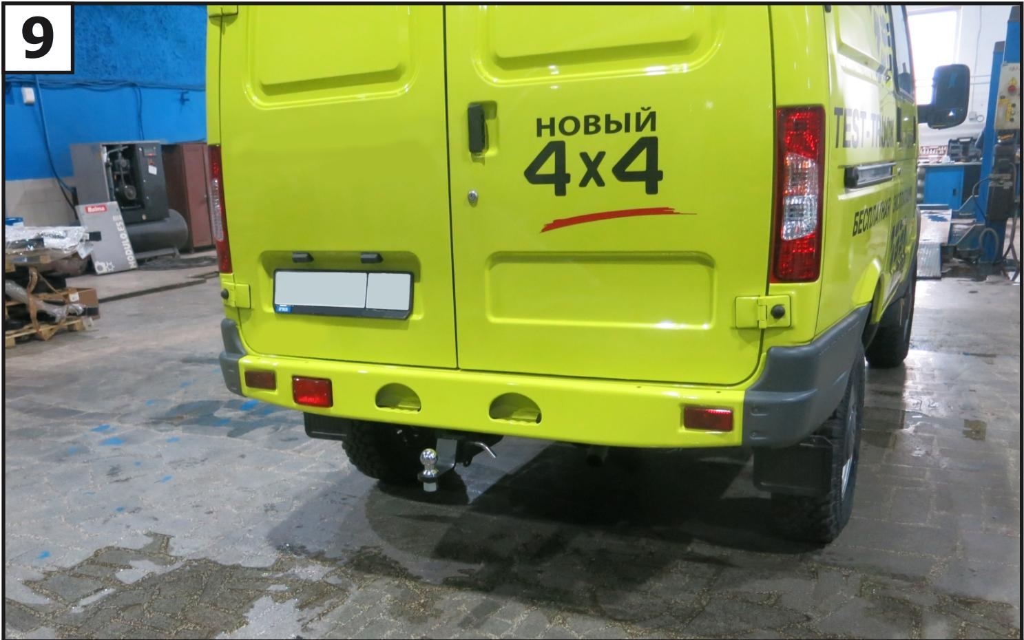
**Затянуть все резьбовые соединения. Моменты затяжки: M8=25 Нм, M10=47 Нм, M24=95 Нм.**
