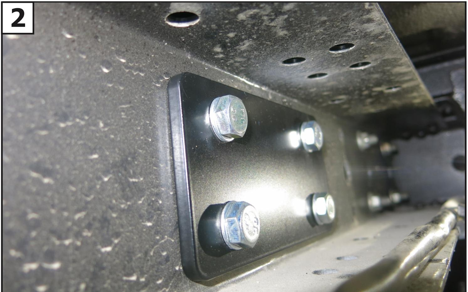
Установить прижимную пластину (4) на раму автомобиля с болтами M10x1,25x40 (12) и шайбами 10 (18).
