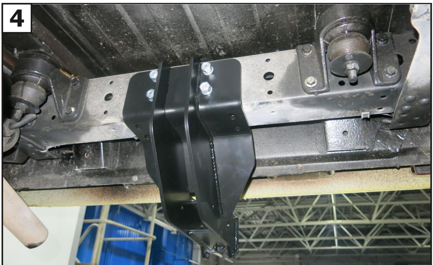
Установить основание (1) на болты прижимной пластины, закрепив гайками M10x1.25 (14) с шайбами 10 (18) и шайбами 10 пружинными (19).
