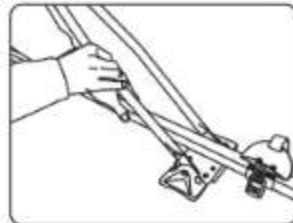
4. Соедините несущую балку в сборе и кронштейн в помощь двух крепёжных скоб. Между скобой и балкой проложите резиновый п-образный профиль, отрезав его по длине. С нижней стороны кронштейна на резьбу скоб навинтите, не затягивая, гайки М6 с шайбами.
