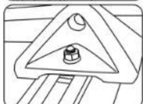
7. Установите на переднюю дугу собранный кронштейн со штангами таким образом чтобы винты переходников проходили в отверстия. Зафиксируйте винты гайками.
