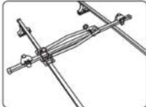
2. Возьмите две верхних части обоймы, соедините их винтом со втулкой и гайкой и установите на несущую балку крепления в месте пересечения её с задней поперечной дугой багажника.
