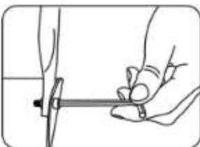
4. Установите велосипед на велокрепление, зафиксируйте колёса ремнями. Передвигая кронштейн со штангами по несущей балке, найдите оптимальное положение, при котором захваты наиболее плотно фиксируют раму велосипеда. Снимите велосипед с крепления и окончательно закрепите кронштейн, затянув гайки на скобах.
