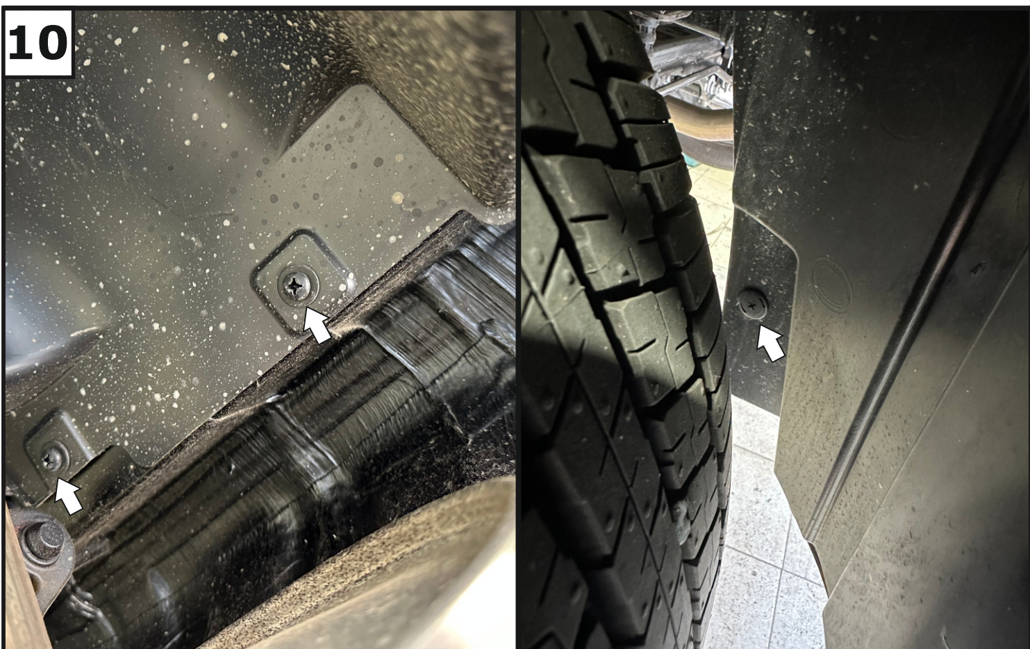
Демонтировать боковые накладки, выкрутив болты с правой и левой стороны.
