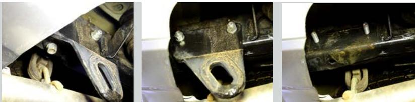
**ШАГ 2.** Освободите глушитель с посадочного места для удобства установки кронштейна. Установите кронштейн, совместив отверстия кронштейна со штатными шпильками в лонжероне. Соедините всё с помощью штатных гаек и шайб.
