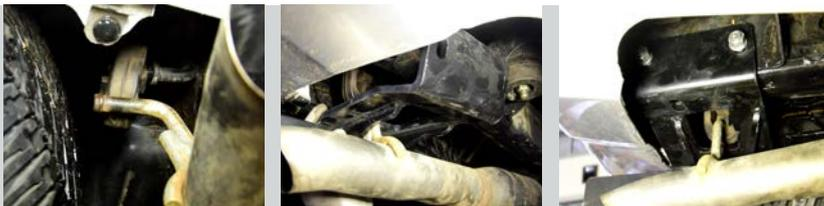
**ШАГ 3.** Установите закладную пластину в нишу правого лонжерона продев шпильку пластины в отверстия лонжерона и кронштейна как показано на фото. Закрепите кронштейн с помощью гайки М12 через пружинную шайбу М12 и шайбу М12. Повторите на левой стороне.
