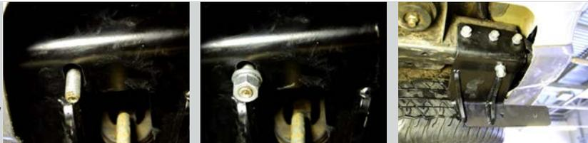
**ШАГ 4.** Для установки фаркопа совместите отверстия в сварном кронштейне с резьбовыми отверстиями кронштейнов и соедините всё с помощью болтов М10, через шайбы М10 и гайки М10. Затяните все резьбовые соединения.
