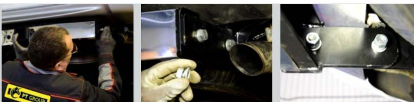
**ШАГ 5.** Установите съемный шар в сборе и закрепите его пальцем гнутым со шплинтом. Зафиксируйте съемный шар болтом М10х20. Установка завершена.
