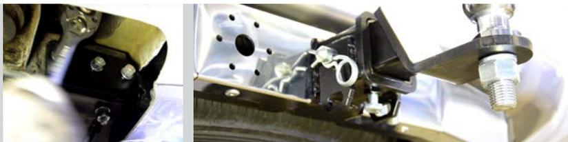
Тип соединения: шаровый; Диаметр сцепного шара: 50 мм.; Масса комплекта ТСУ 21031501: 20,8 кг.
