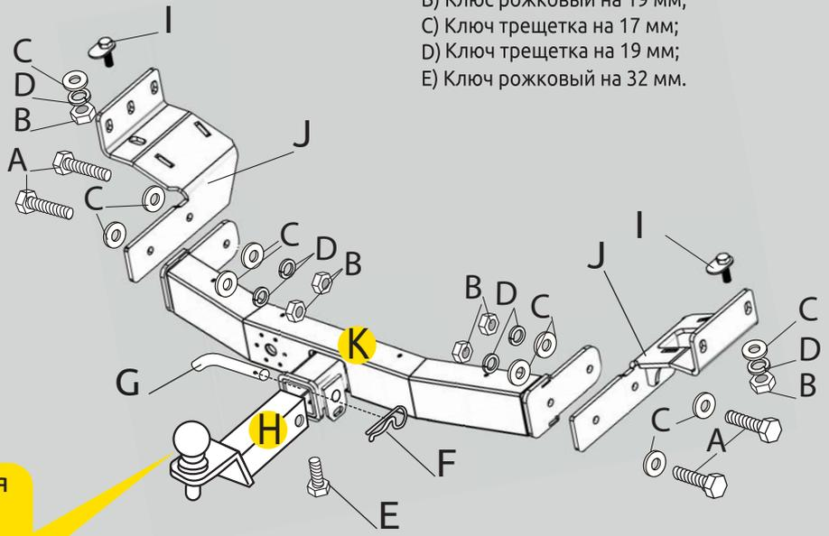
Не предназначен для установки багажных платформ с креплением на шар
