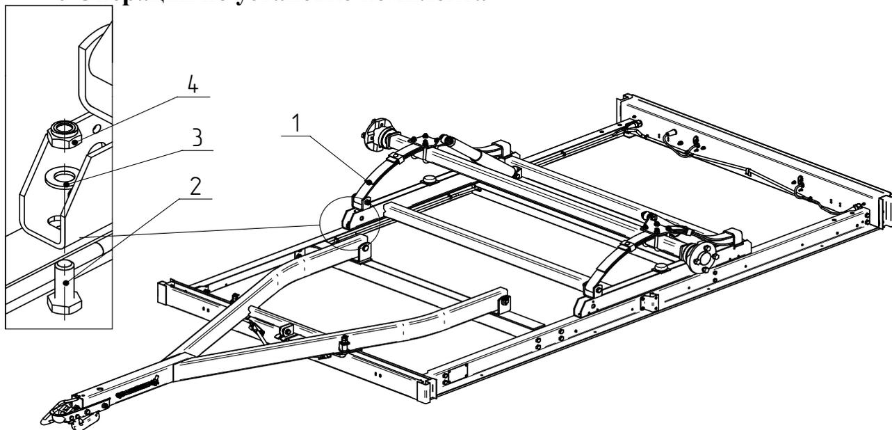
Момент затяжки гаек 5.8...7 кгс\*м. Повторное завинчивание самостопорящейся гайки не допускается — применять новую. Гайки крепления накладок затягивать при полной массе прицепа, момент затяжки 3.5...4.2 кгс\*м.
