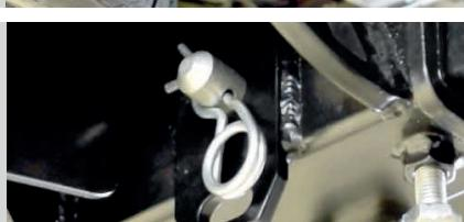
**ШАГ 5.** Затяните шар с помощью ключа на 32 мм. Вкрутите стопорный винт M10x20 снизу. Установка завершена.
