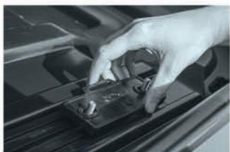
3 Придерживая скобы изнутри автобокса, установите проставки усилителя и наживите гайки «барашек».
