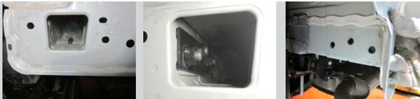
**ШАГ 3.** Установите кронштейны совместив отверстия в кронштейнах и в лонжеронах, и с закладными шпильками M8. Закрепите кронштейны с помощью болтов M12 через шайбы и гроверы. И с помощью гаек M8 через шайбы 8. Установите бампер.
