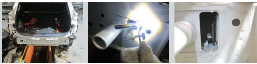
**ШАГ 2.** Аналогичным образом установите закладные шпильки M8 и пластины с левой стороны автомобиля. Убедитесь, что отверстия в закладных пластинах соосны с отверстиями в лонжеронах автомобиля.
