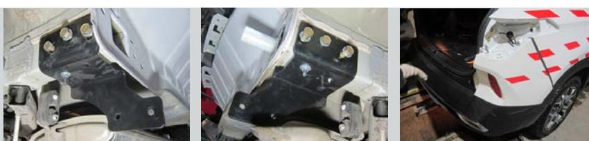
**ШАГ 4.** Установите кронштейн розетки и закрепите его на шпильке с помощью гайки M10 через шайбу 10 увеличенную и шайбу 10 пружинную. Закрепите центральный кронштейн на боковых с помощью болтов M12x1,25x40 через шайбы с помощью гаек.
