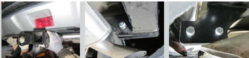
**ШАГ** Установите съемный шар в сборе и закрепите его пальцем гнутым со шплинтом. Зафиксируйте съемный шар болтом M10x20 снизу. Затяните стёмный шар с помощью ключа на 38 мм. Перед установкой фартуков просверлите в них отверстия под шпильки.
