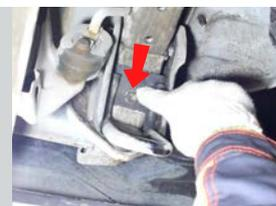
**ШАГ 2.** Установите кронштейн (поз. Q) и прикрутите его с помощью болтов M12x110x1,25 продетых сквозь лонжерон, гайками M12x1,25 через шайбы M12 и шайбы пружинные M12. Кронштейн устанавливается с внутренней стороны лонжерона гибом в центр автомобиля.
