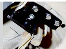
**ШАГ 4.** Для установки фаркопа совместите отверстия в сварном кронштейне с резьбовыми отверстиями кронштейнов и соедините всё с помощью болтов M10x30x1,25, через шайбы M10 и шайбы пружинные M10. Затяните все резьбовые соединения.
