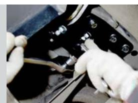
**ШАГ 5.** Установите кронштейн крепления электрической розетки гайкой M10. Установите съемный шар в сборе и закрепите его пальцем гнутым со шплинтом. Зафиксируйте съемный шар болтом M10x20. Установка завершена.
