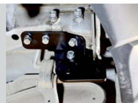
**ШАГ 3.** Установите пластию гнутую (поз. P) и прикрутите её к лонжерону с помощью болтов M10x40x1,25 через шайбы M10 и к кронштейну с помощью болта M10x30x1,25 через шайбы M10 с двух сторон, шайбы пруж. M10 и гайки M10x1,25. Повторите шаги 2-3 для другой стороны.
