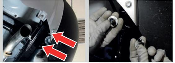
**ШАГ 3.** Для установки центрального кронштейна совместите отверстия в кронштейне с отверстиями в боковых кронштейнах и соедините болтами М10х40, гайками М10 через гроверные шайбы М10 и шайбы М10.
