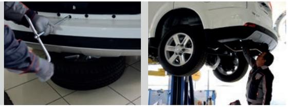
**ШАГ 2.** Выкрутите два штатных болта М12 крепления задней балки, как показано на фото. Установите кронштейн боковой на раму, совместив отверстия в кронштейне с отверстиями крепления задней балки и закрутите его входящими в комплект поставки болтами М12х45х1.25 с юбкой, но не затягивайте.
