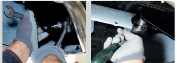
**ШАГ 5.** Установите съемный шар в сборе и закрепите его пальцем гнутым с шплинтом.
