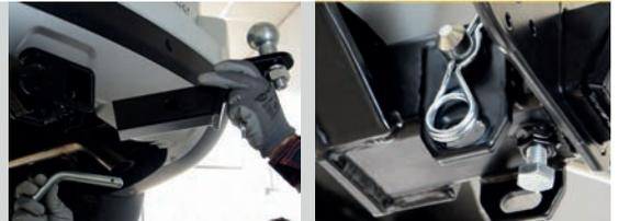
Тип соединения: шаровый; Диаметр сцепного шара: 50 мм.; Масса комплекта ТСУ 19011501: 10 кг.
