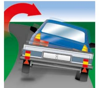
Das Testgespann mit einem ungebremsten Anhänger bricht bei einer Notbremsung in einer Kurve aus, schleudert und kann nicht gehalten werden.
