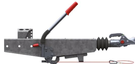
Handbremshebel geschlossen (Standbremse vorwärts)
