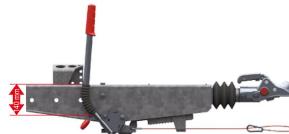
Handbremshebel geschlossen (Standbremse rückwärts, Bremse optimal eingestellt)
