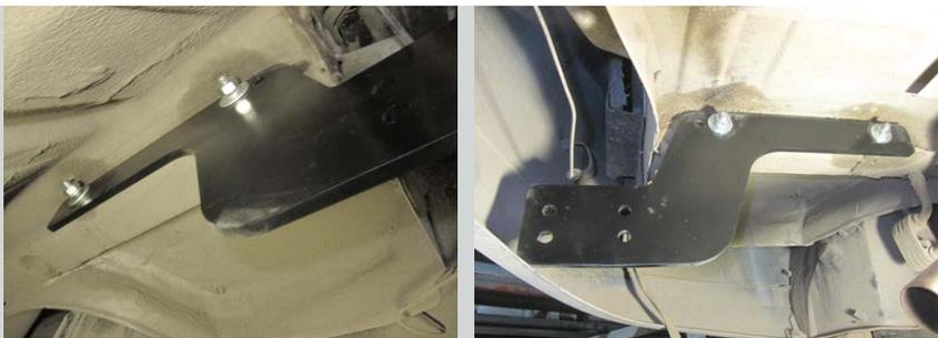
**ШАГ 3.** Установите центральный кронштейн с помощью болтов М10х40х1,25 через шайбы на 10 с помощью гаек М10х1,25. **Верхние отверстия кронштейнов для установки на Logan, нижние отверстия для установки на Logan Stepway.** Выровняйте центральный кронштейн относительно бампера автомобиля и затяните все соединения.
