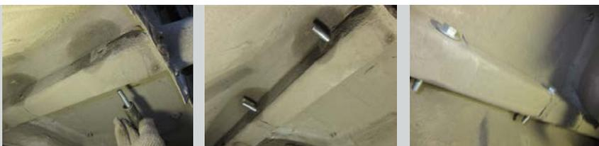
**ШАГ 2.** Установите кронштейны, совместив отверстия в кронштейнах и в лонжеронах, Закрепите кронштейны с помощью гаек М10 через шайбы на 10 и гроверы на 10. **Кронштейны устанавливаются гибом к центру автомобиля.** Соединения не затягивать.
