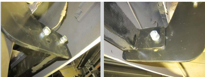
**ШАГ 4.** Установите съемный шар в сборе и закрепите его пальцем гнутым со шплинтом. Зафиксируйте съемный шар болтом М10х20 снизу. Затяните съёмный шар с помощью ключа на 38 мм. Установка завершена.
