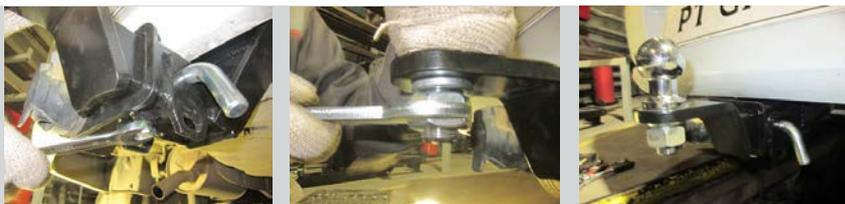
Тип соединения: шаровый; Диаметр сцепного шара: 50 мм.; Масса комплекта ТСУ 07031501: 16,2 кг.
