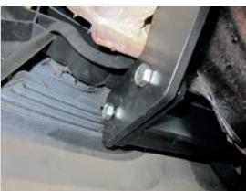
**ШАГ 5.** Установите кронштейн крепления электрической розетки, стопорный винт снизу. Верните глушитель на посадочное место. Закрепите нижнюю часть бампера штатными винтами.
