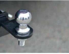
Тип соединения: шаровый; Диаметр сцепного шара: 50 мм.; Масса комплекта ТСУ 01501501: 13 кг.
