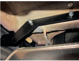
**ШАГ 4.** При необходимости подрежьте бампер с внутр. стороны. Установите центральную часть тягово-сцепного устройства прикрепив её к кронштейнам с помощью крепежных винтов из комплекта поставки. Установите шар в сборе и затяните его ключом на 32мм.
