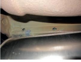
**ШАГ 3.** Проденьте сквозь лонжерон крепежные винты из комплекта поставки шляпками наружу автомобиля.
