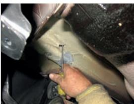
**ШАГ 2.** Удалите пластиковые заглушки с технологических отверстий с каждой стороны задних лонжеронов.
