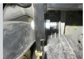
**ШАГ 4.** Установите кронштейн розетки и закрепите его на шпильке с помощью гайки M10 через шайбу 10 увеличенную и шайбу 10 пружинную. Установите съемный шар в сборе и закрепите его пальцем гнутым со шплинтом.
