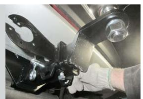
**ШАГ 5.** Зафиксируйте съемный шар болтом M10x20 снизу. Затяните съемный шар с помощью ключа на 38 мм. Закрепите брызговики. Установка завершена.
