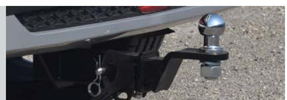
Тип соединения: шаровый; Диаметр сцепного шара: 50 мм.; Масса комплекта ТСУ 06081502: 17,8 кг.
