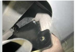
**ШАГ 3.** Установите кронштейн центральный, совместив отверстия в кронштейнах боковых и центральном. Закрепите кронштейн с помощью болтов M10x40x1,25, гайками M10x1,25 через шайбы 10 и шайбы пружинные 10. Отрегулируйте положение центрального кронштейна относительно бампера и затяните все соединения.
