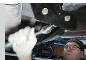
**ШАГ 5** Установите съемный шар в сборе и закрепите его пальцем гнутым со шплинтом. Зафиксируйте съемный шар болтом M10x20 снизу. Затяните съемный шар с помощью ключа на 38 мм. Перед установкой фартуков просверлите в них отверстия под шпильки.
