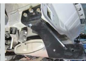
**ШАГ 4.** Установите бампер. Установите центральный кронштейн совместив отверстия центрального кронштейна и боковых кронштейнов. Соедините их с помощью болтов M12x1,25x40 гайками M12x1,25 через шайбы 12 с двух сторон.
