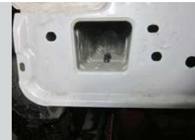
**ШАГ 3.** Установите кронштейны совместив отверстия в кронштейнах и в лонжеронах, и с закладными шпильками M8. Закрепите кронштейны с помощью болтов M12x1,25x40 через шайбы и гроверы. И с помощью гаек M8 через шайбы 8.
