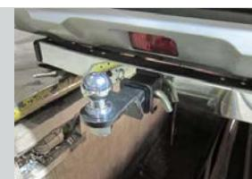
Тип соединения: шаровый; Диаметр сцепного шара: 50 мм.; Масса комплекта ТСУ 06071502: 24,3 кг.
