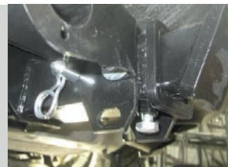
Тип соединения: шаровый; Диаметр сцепного шара: 50 мм.; Масса комплекта ТСУ 06041502: 17,6 кг.
