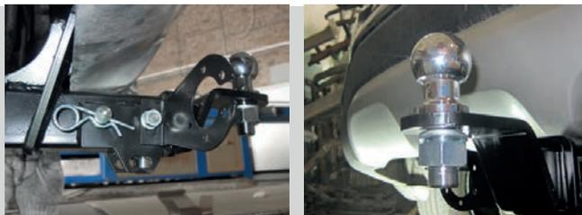
Тип соединения: шаровый; Диаметр сцепного шара: 50 мм.; Масса комплекта ТСУ 06031501: 13 кг.
